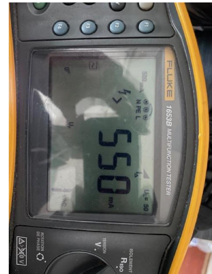
B.2.3.1 h) : Au moins un dispositif de protection différentielle ne fonctionne pas pour son seuil de déclenchement.
